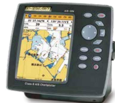
クラスBのAISを内蔵したGPSプロッター「AIS-50N」。なお、NFシリーズには、別売りのAIS送受信機を接続すれば、AIS情報の表示も可能だ
